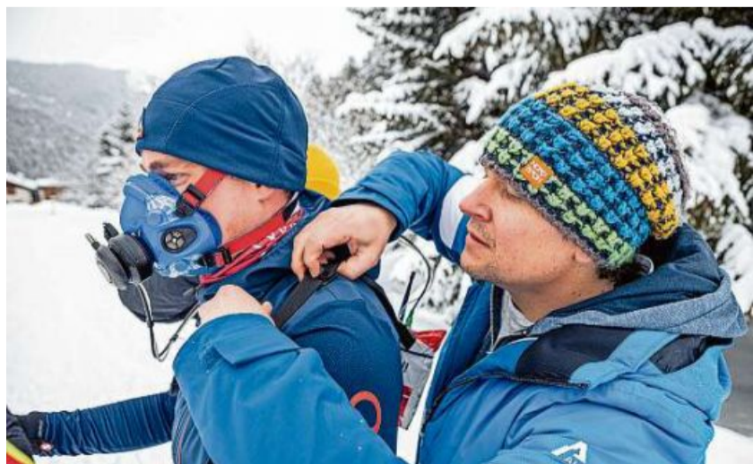
Forschung auf der Loipe: Mittels Spirometer werden in Davos bei einem Langläufer Atemgase und relative Sauerstoffsättigung der Muskulatur gemessen.
